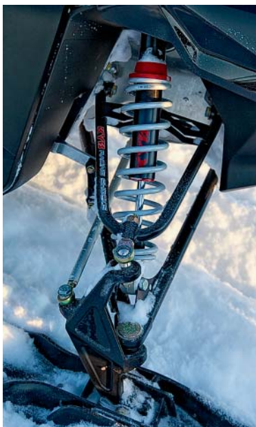
На передних двояных А-образных рычагах трудятся амортизаторы KYB, ход лыж — 242 мм
