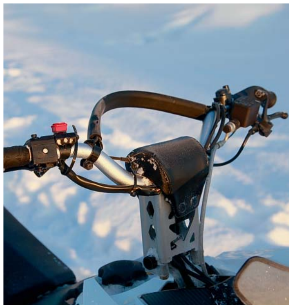
Высокий алюминиевый руль с удобно изогнутыми «рогами» и горная стропа помогают управлять Xtrim Boondocker 800R E-TEC
